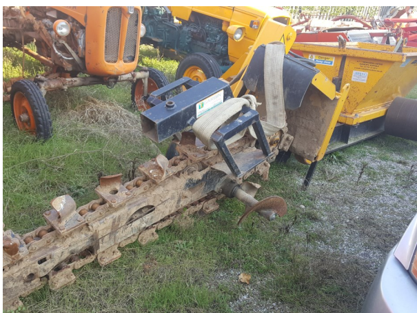
CATENARIA PORTATA SUL SOLLEVAMENTO DEL TRATTORE
